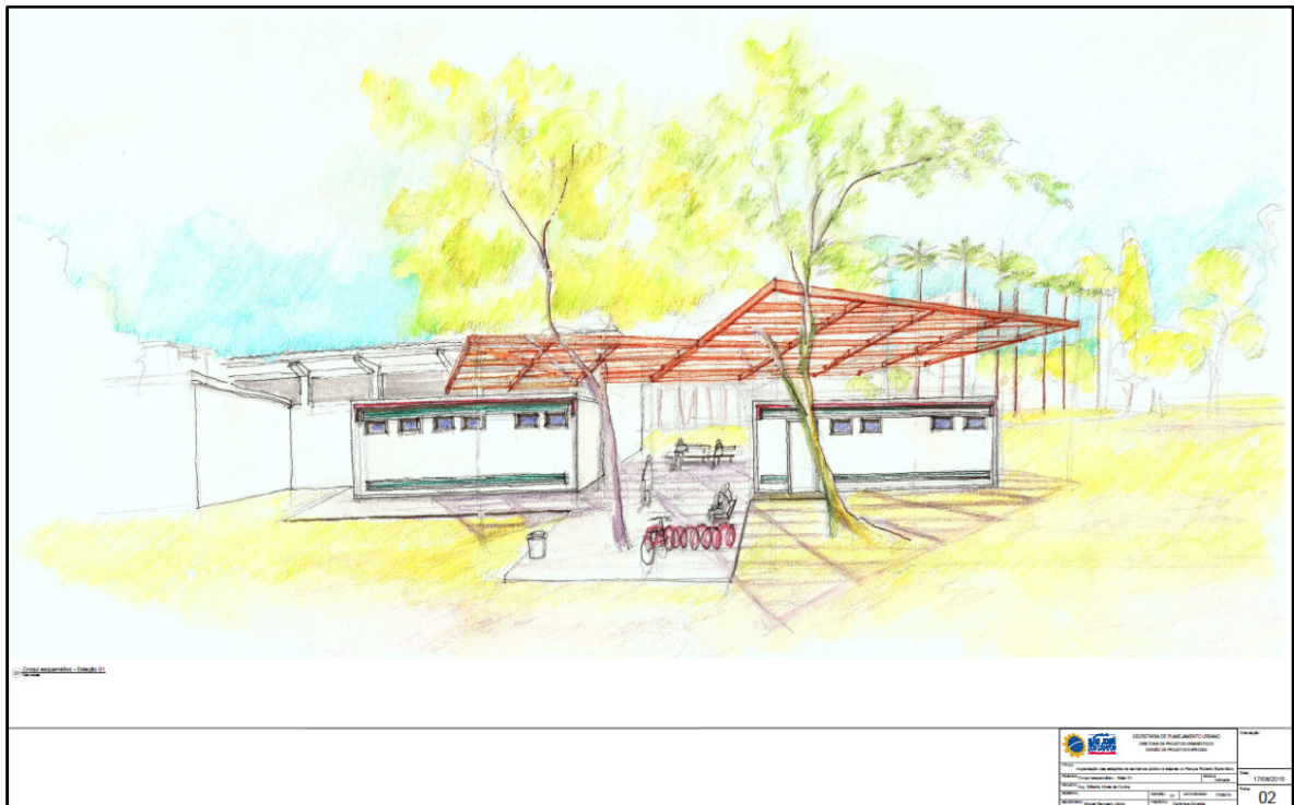
Ilustração 11 - Perspectiva da estação de apoio com contêineres de sanitários, contêineres de alimentação, bancos, bebedouros, bicicletários e pergolados (Próximo ao Galpão Gaivotas)
