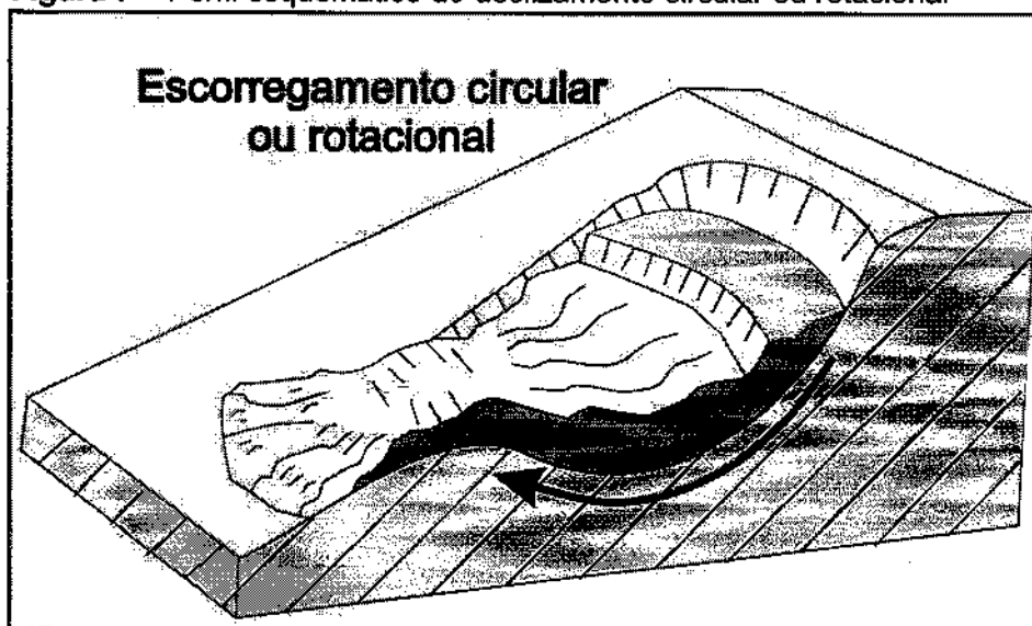
Figura 7 – Perfil esquemático do deslizamento circular ou rotacional
